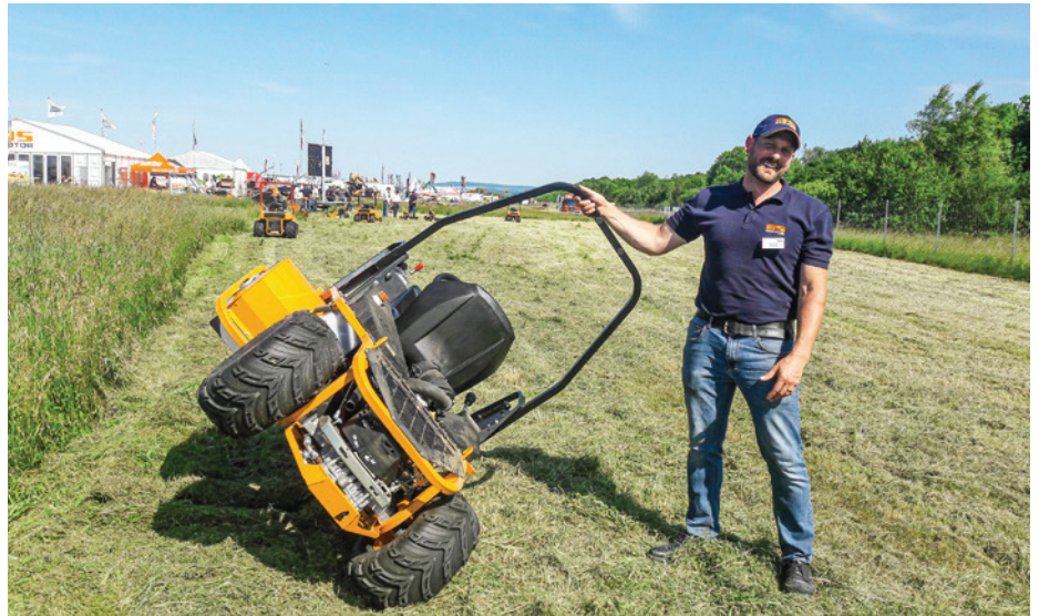
Georg-Otto Fuchs, Vermarktingsleiter bei AS-Motor, zeigte in Eisenach den Schlegelmäher AS 1040 YAK 4WD, der 2018 auf den Markt kam. Er zerkleinert im steilen Gelände Aufwuchs bis zu 1,50 m. Wesentlich für die Geländegängigkeit ist der niedrige Schwerpunkt und die optimale Gewichtsbalance.
