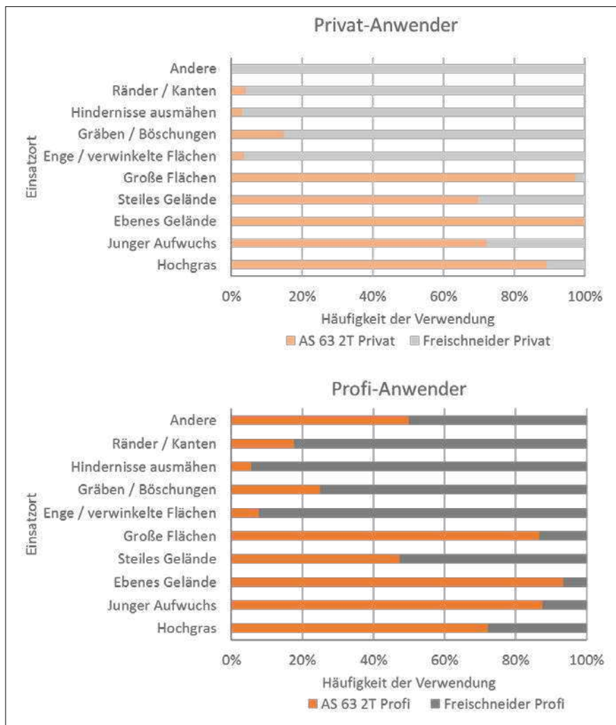
Abb. 5: Flächendetails der von den befragten Personen (n=65) gepflegten Grünflächen prozentual für Freischneider und Hochgrasmäher AS 63 2T, getrennt nach Anwendergruppe.
